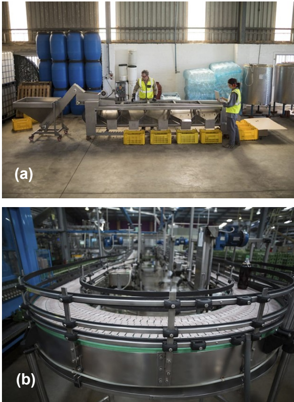
Fig. 7 Representação de linha de produção em metodologia manual ou semiautomática (a) versus metodologia baseada em automação de processos (b). Fonte: Tünkers do Brasil (2020)
