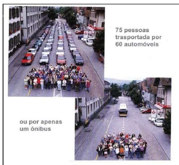
Fig. 1 Capacidade do ônibus em relação ao carro particular. Fonte: Guia PlanMob (Brasil, 2007).
